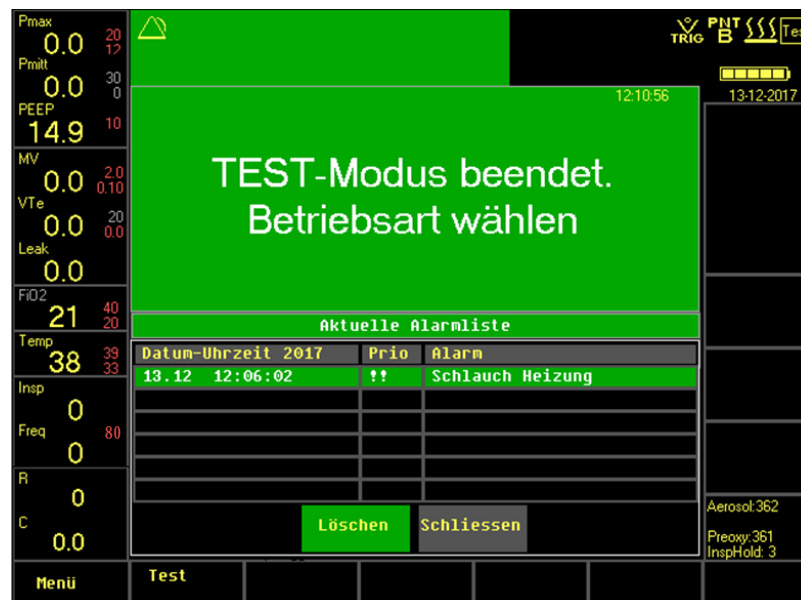
Abb. 73: Test-Modus beendet, aufgetretene Alarme werden automatisch angezeigt
