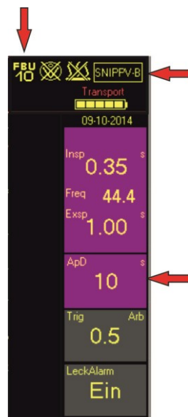
Abb. 96: SNIPPV-mit frequenzkontrollierter Backup-Beatmung
