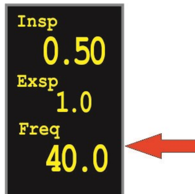
Abb. 75: Version mit einstellbarer Atemfrequenz
