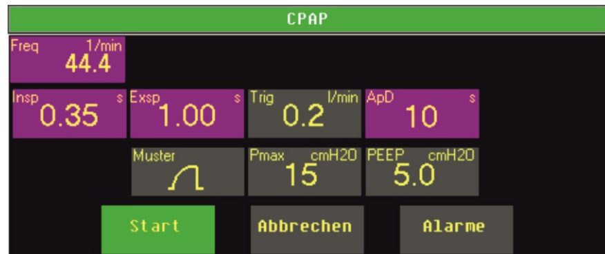
Abb. 98: Parametereinstellung CPAP (mit frequenzkontrollierter Backup-Beatmung)
