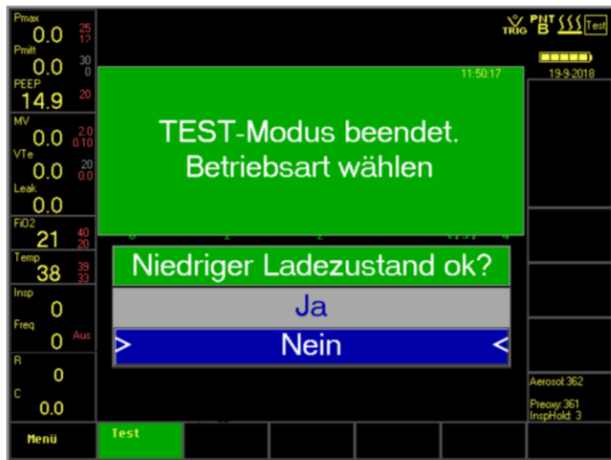
Abb. 117: Betrieb mit niedrigem Akku-Ladezustand
