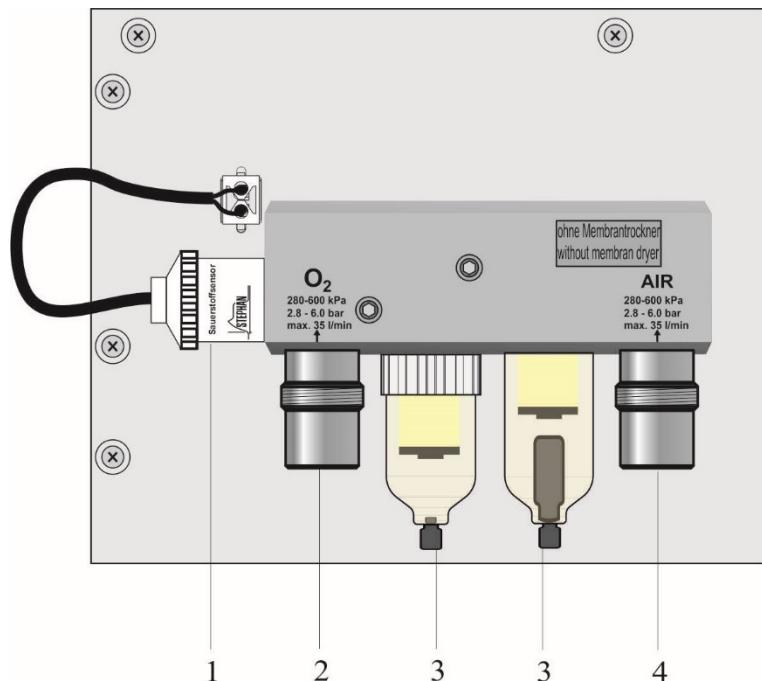
Fig. 26: Pneumatic module
