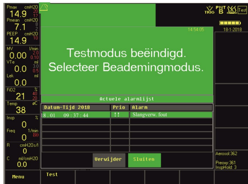
Afb. 73: Testmodus beëindigd, opgetreden alarmen worden automatisch weergegeven
